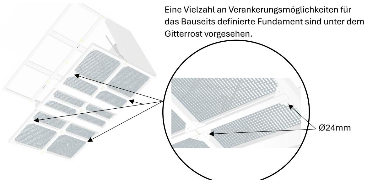
Im Lieferumfang enthalten sind 4x M20 Gewindestangen mit einer Länge von ca. 30cm samt Kleinmaterial wie Beilagscheiben Stopmuttern und Kleber.
